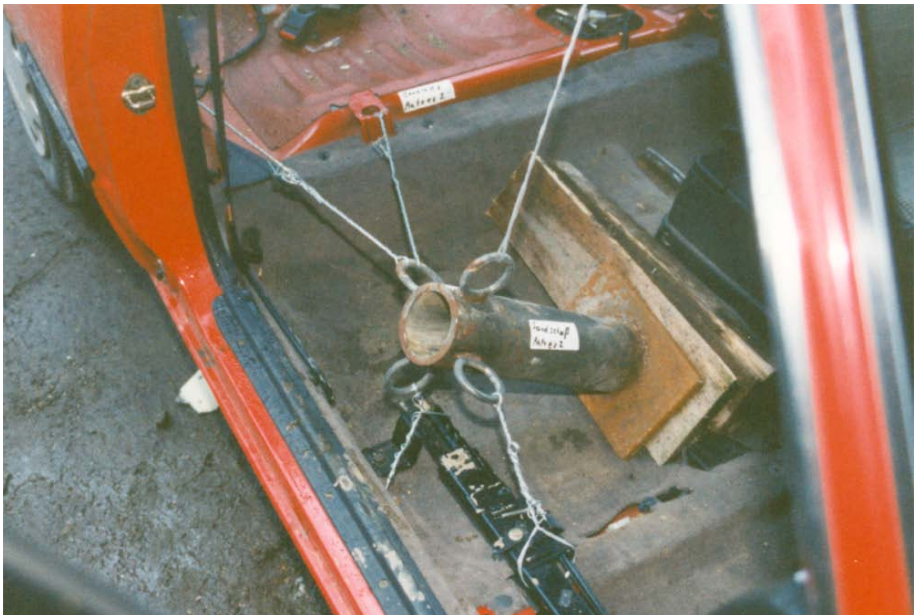
Abb. 179: Einbau eines Shotgunmörser zur Bewegung der Tür
