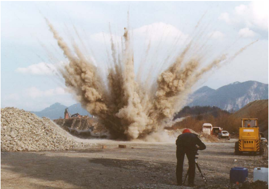
Abb. 175: Zementstaubexplosion mit 200 g Sprengstoffpatrone im Lehrgang
