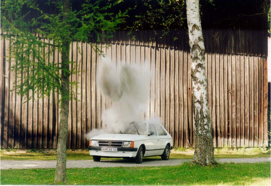
Abb. 112: Zwei Shotgunmörser mit Sandladung schießen eine Windschutzscheibe heraus
