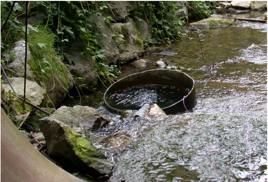
Abb. 158: Vorbereitung mit zylindrischem Mörser für Wasserschuss, 180 g Schwarzpulver
