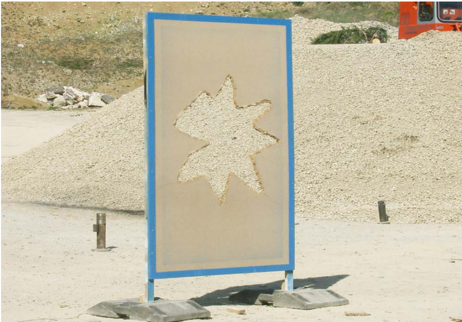
Abb. 171: Zerstörung von Dekorationen mit Sprengschnur im Lehrgang
