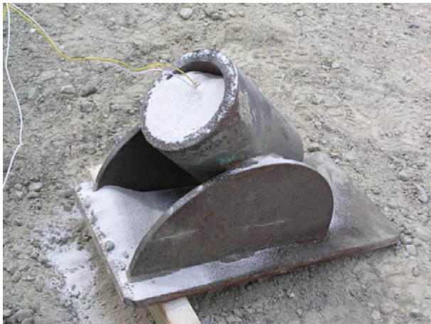
Abb. 160: Abgewinkelter Sandschussmörser zur Splitterverteilung
