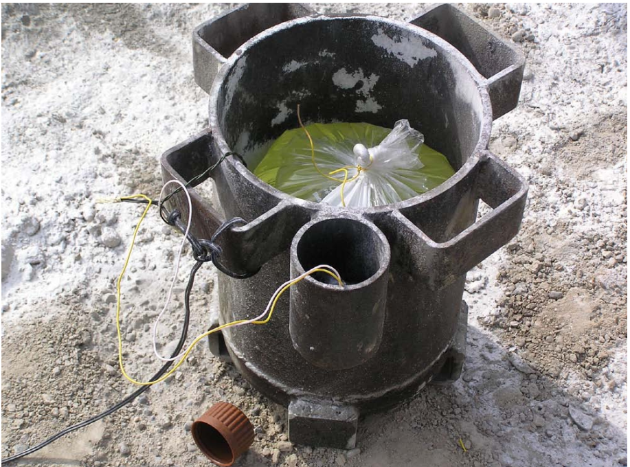
Abb. 151: Zylindrischer Mörser mit 5 Liter Benzin, DM 54 und Zündladung
