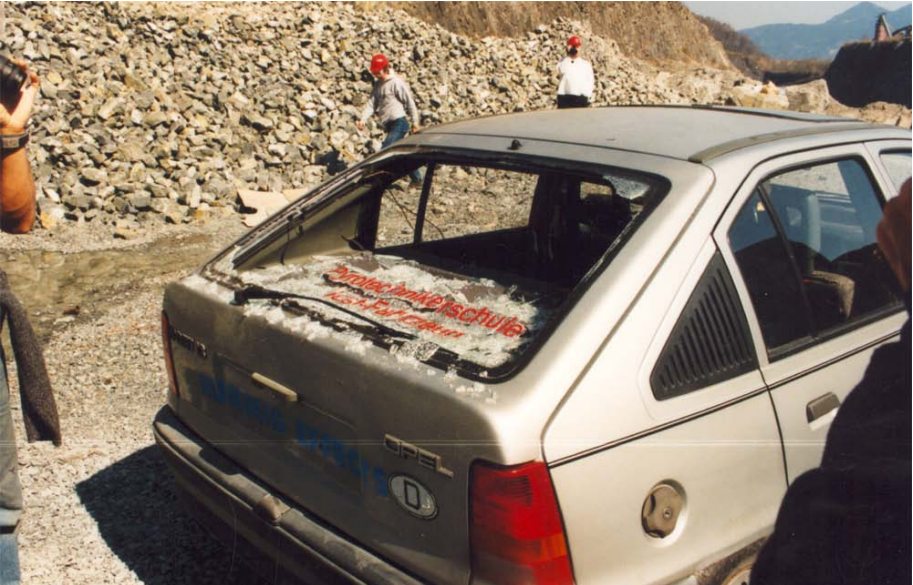
Abb. 167: Wegsprengen einer Scheibe mit aufgelegter Sprengschnur
