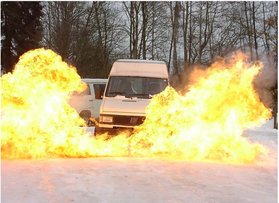
Abb. 105: Gaskartuschenschussgerät groß, oben mangelhaft gezündet
