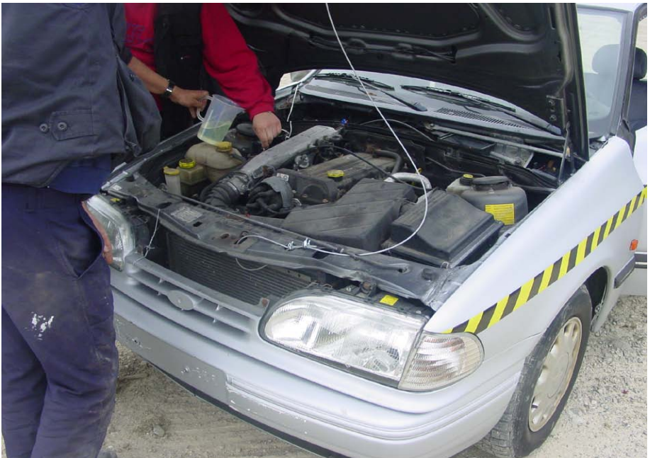
Abb. 183: Wegfliegende Haube und Türe mit Seil sichern
