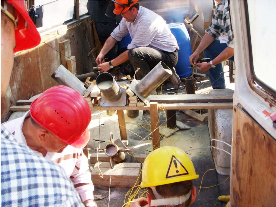
Abb. 187: Aufbau einer zusammengesetzten Explosion im Lehrgang
