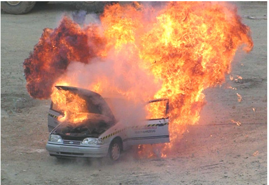
Abb. 186: Autoexplosion mit 4 Liter Benzin, 3 Shotguns f. Türen und Haube
