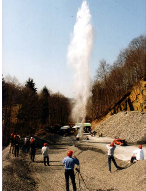
Abb. 78: DM 31, Wasserschuss aus Mörser 80 cm, 300 Liter Wasser
