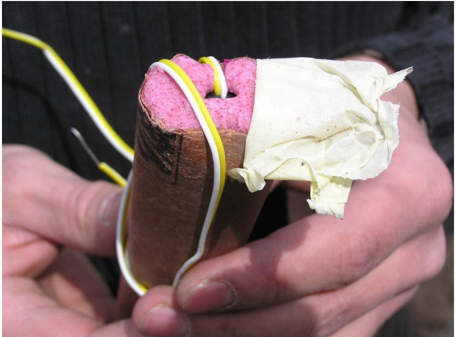
Abb. 177: Anfertigen einer Schlagpatrone
