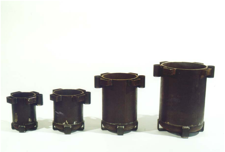
Abb. 149: Zylindrische Mörser, 20 bis 40 cm mit Flashpot
