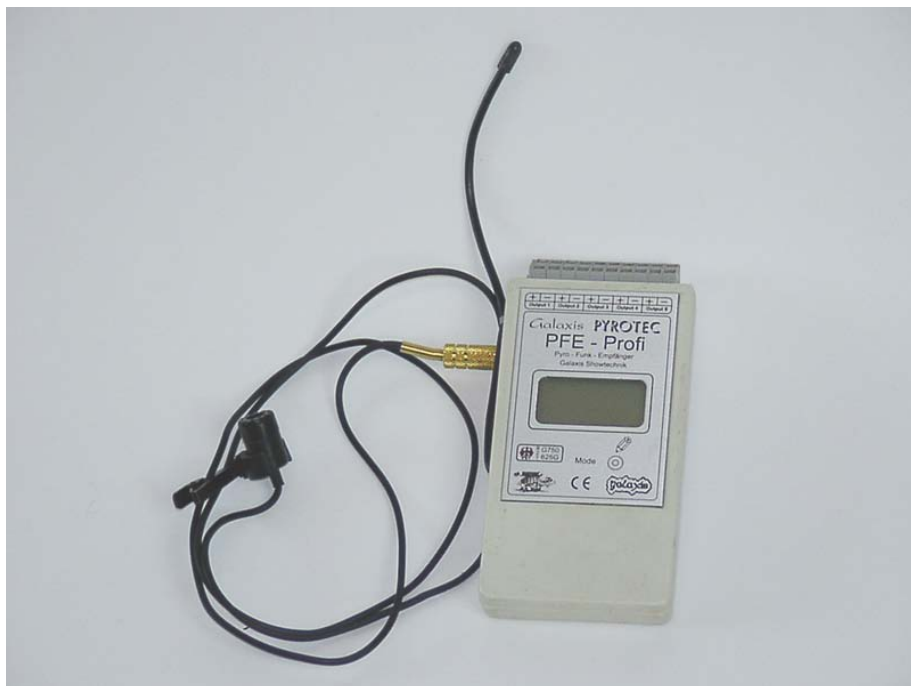
Abb. 24: 5-Kanal Funkzündgerät mit Schallauslösung
