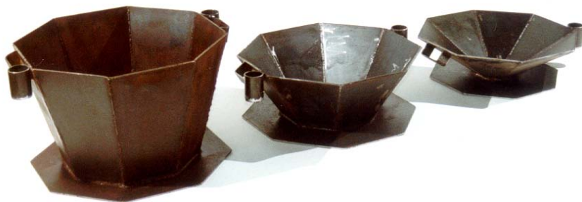
Abb. 129: Konische Mörser mit verschiedenem Wandneigungswinkel
