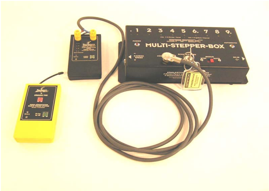
Abb. 22: Funkzündgerät von Safex; 1-Kanal, zusätzlich Stepper 9-Kanal
