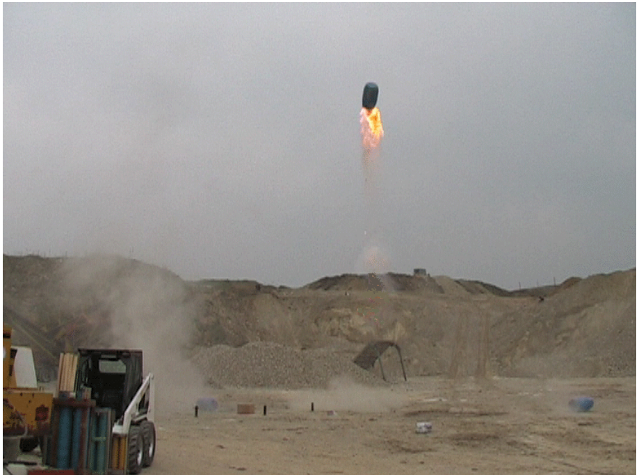
Abb. 115: Fassschuss mit Shotgunmörser
