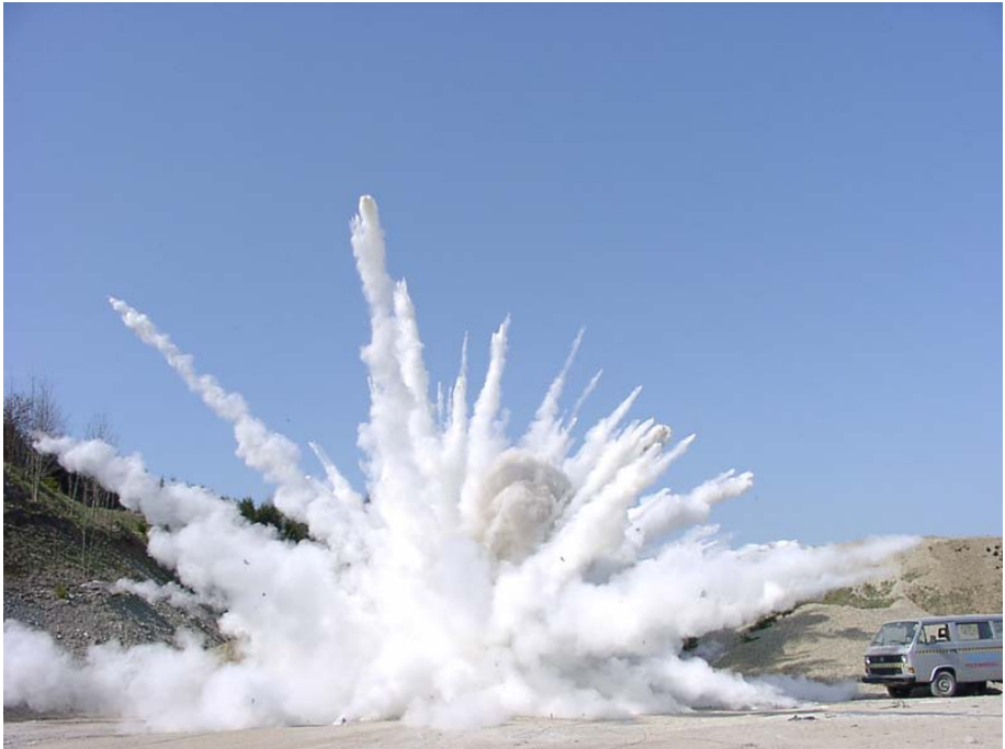
Abb. 79: DM 31 mit 70 kg Mehl ohne Zündladung
