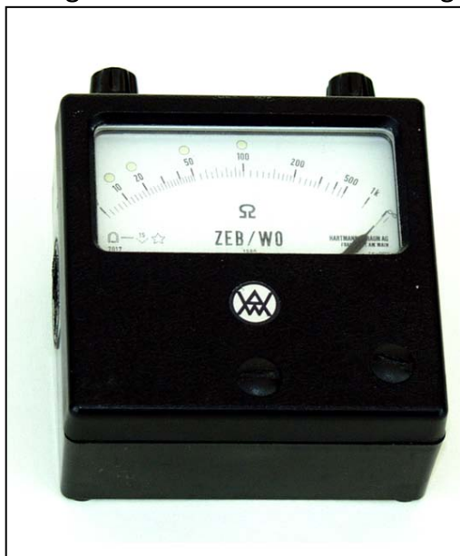
Abb. 53: Ohmmeter, zugelassen für Sprengarbeiten
