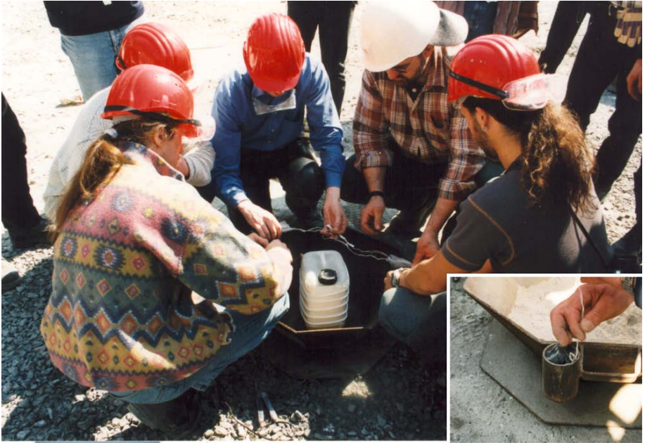
Abb. 137: Benzinkanister mit verteilter Sprengschnur und Zündladung
