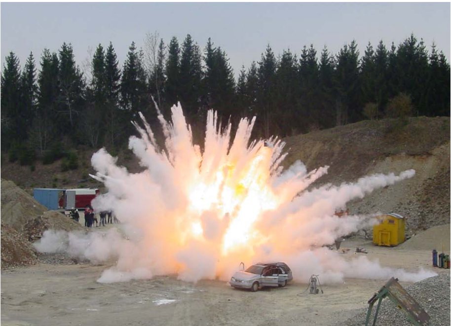
Abb. 147: Vergleich: 70 kg Mehl mit Titaniumsalut 100 mm, etwas schärfer
