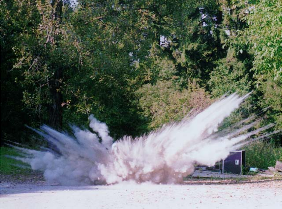
Abb. 128: Zementstaubexplosion mit flachem Mörser
