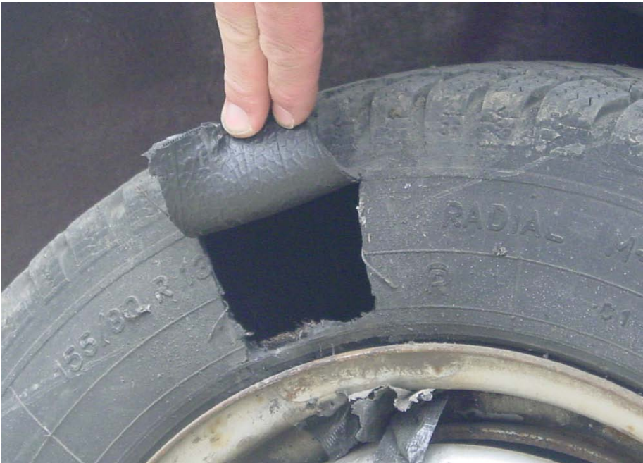
Abb. 163: Reifen mit Schneidladung schnell entlüftet
