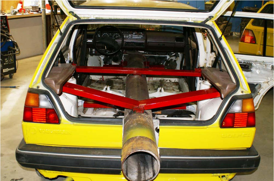
Abb. 120: Stempelschuss waagrecht zum Wegschießen von Fahrzeugen
