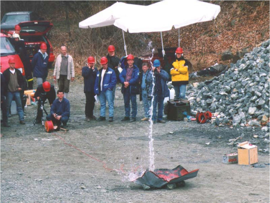
Abb. 31: Demonstration der Wirkung eines Sprengzünders in Wasser – "schlagwettersicher" (Kupferhülse) oder "nicht schlagwettersicher" (Alu-Hülse).
